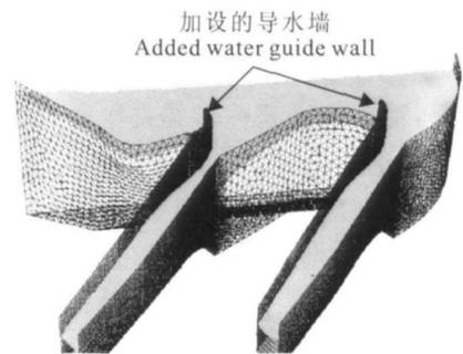
图 6 甘肃九甸峡水利枢纽工程双洞式溢洪道优化方案计算自由水面的空间形态
