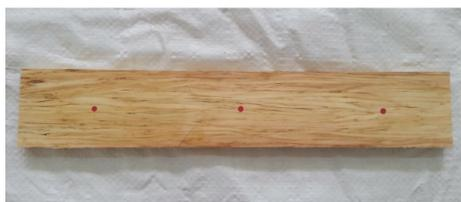
图 3 桑枝重组方材的尺寸稳定性试验试件
