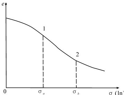
图 2 侧限压缩试验曲线
