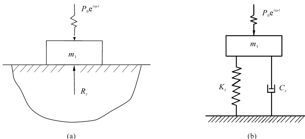
图1 半空间体系和等效集总体系竖向振动计算简图
