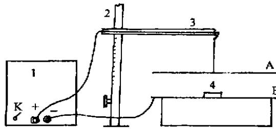
图1 高压静电场处理米曲霉孢子悬液装置图
